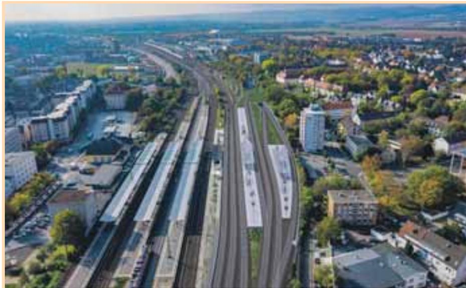
**Neue Gleise.** So soll der Höchstler Bahnhof ab 2028 von oben aussehen. Rechts an der Nordseite sind die neuen Bahnsteige der Regionalaltengente West (RTW) zu sehen, deren Schienen kurz hinter dem Bahnhof in einem ebenfalls neuen Tunnel verschwinden, der die neue Linie unter den anderen Gleisen hindurch Richtung Leunastraße führen wird. Ende März fand eine Informationsveranstaltung im BiKuZ statt. Mehr dazu lesen Sie auf Seite 5. Grafik: RTW
